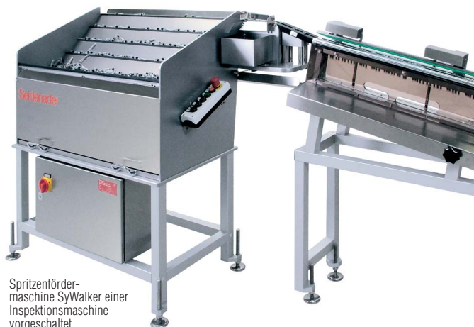
Rundriemen transportieren die Spritzen zur Auslaufrutsche
