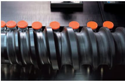
geteilte Schnecke am Einlauf zum Leerfahren der Maschine
